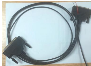
图 9 iLuma 公司提供的 SCSI 68PIN to 37PIN 专用电缆
