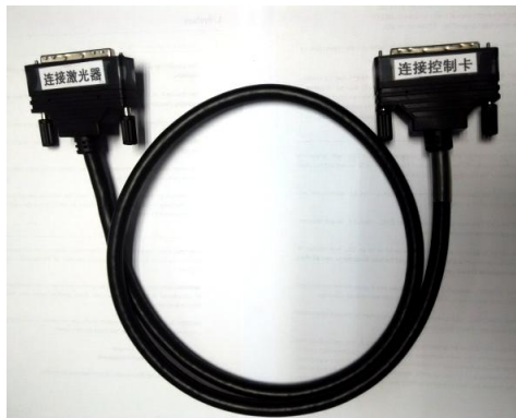
图 4 iLuma 公司提供的 SCSI 68PIN to SCSI 68PIN 专用电缆
